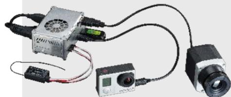
Mögliche Erweiterung mit GoPro Hero Kamera, GPS USB-Stick und 2,4 GHz Flugsteuerungsempfänger
