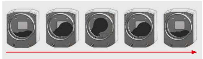
Zur Offsetreferenzierung wird das Gesichtsfeld des Infrarot-Sensorarrays kurzzeitig geschlossen
