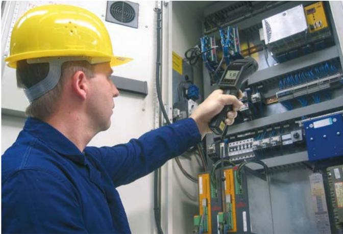
Detaillierte Infrarottemperaturmessung an einer elektrischen Steuerung mit Hilfe der eingebauten Scharfpunktoptik des optris® LS LT im 1 Millimeterbereich
