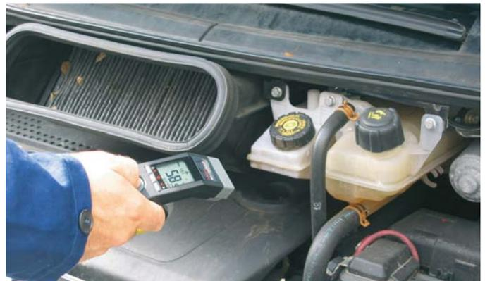
Prüfung des Heizsystems
