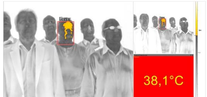
Anlage zum Hauttemperaturscreening an Reisenden mit Präzisionsreferenzstrahler
