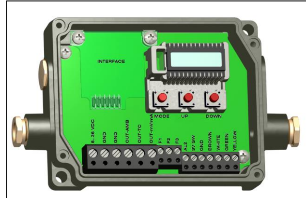
Abbildung 11: Geöffnete Elektronik-Box (LT/ LTF/ MT/ F2/ F6/ G5/ P7) mit Anschlussklemmen
