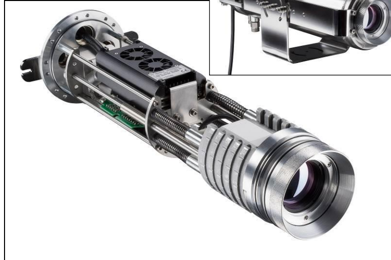
IR-Kamera mit NetBox im CoolingJacket Advanced für Umgebungstemperaturen bis 315 °C
