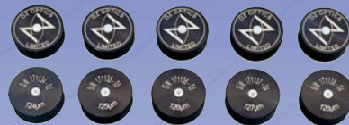
用于光纤外径测量的基规
