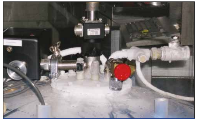
Криостат, измерения температуры
