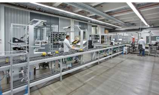
01 I/O-Module mit hoher Varianz können auf dem flexiblen Produktionssystem wirtschaftlich hergestellt werden
