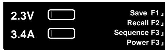
2. 電源の出力設定がパワーオン時に出力スタートとなっている場合、右の画面が表示されます。また本体の制御はローカル設定となっています。画面の数字はカウントダウンで、カウントダウン中に Abort(解除)キー(F1)を押しますと出力は行なわれません。出力を行なう場合は OutputON/OFF キーを押してください。電源投入時の出力の設定は 3.8.2 章を参照してください。
