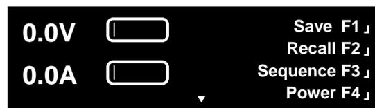
4. 30 秒の暖気時間が経過しますと自動的にタイムアウトスクリーンに変わります。F4 キーを押しますと前の画面(ホームメニュー)に戻ります。
