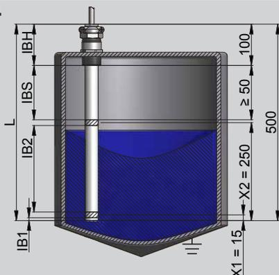
Beispiel für eine 2-Punkt-Sonde aus PTFE mit einer Gesamtlänge von L = 500 mm und einer Halterung von IBH = 100 mm. IBS = 150 mm und erfüllt das Mindestmaß von  $\geq 50$  mm. Der erste Schaltpunkt X1 ist standardmäßig bei 15 mm und der zweite Schaltpunkt X2 wurde bei 250 mm gewählt.
