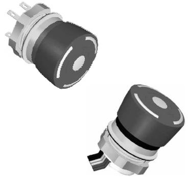
Die Taste kann in Frontplatten mit Stärken von 1 bis 4 mm montiert werden. Sie weist eine maximale Einbautiefe von 13,5 mm auf. Der Flachkabelanschluss kann nach Kundenwunsch konfektioniert werden. Typische Anwendung ist der Einsatz in Handbediengeräten, wie sie in der Prozessautomation, an Kränen, Robotern, beweglichen Arbeitsplattformen und Sicherheitssystemen Verwendung finden.
