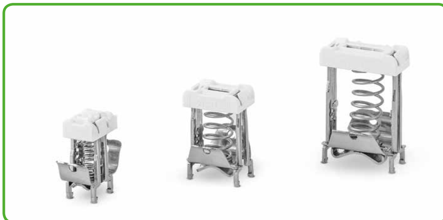
Schirmklemmbügel in drei Größen, für Schirmdurchmesser von 3 mm ... 20 mm
