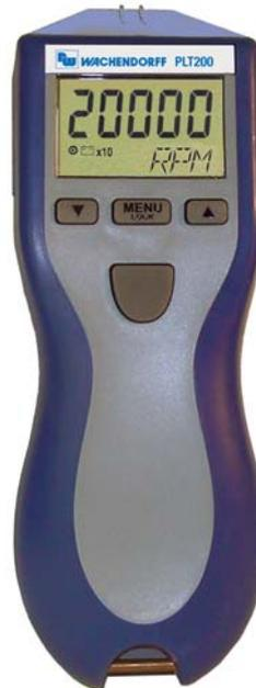
Der Laser-Handtachometer PLT200 ist ein batteriebetriebenes und multifunktionales Handgerät, um Geschwindigkeit, Impulszählung, Summierung und Zeitmessungen durchführen zu können. Aufgrund des Klasse 2M-Lasersensors kann bis auf eine Entfernung von 8 Metern und bis zu einer Drehzahl von 200.000 U/min. präzise gemessen werden. Die Impulserfassung erfolgt über ein entsprechendes Reflexband.
