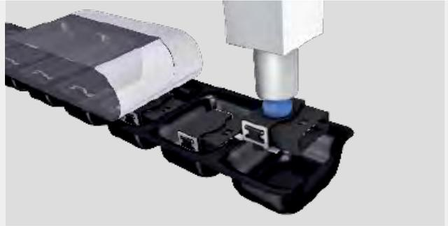
Reflow- und SMD-lötfähige Komponenten für automatisierte Bestückungs- und Lötprozesse
