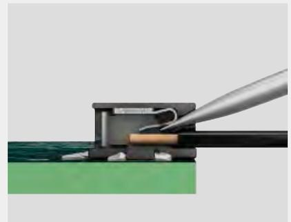
Schneller und werkzeugloser Anschluss von Einzelleitern
