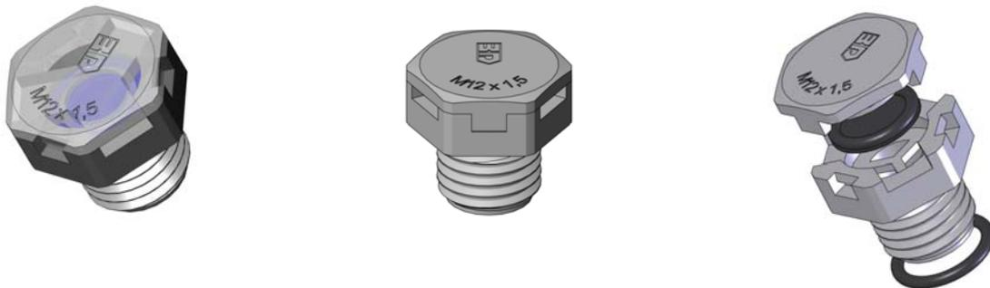
Im Grundkörper des Druckausgleichselements ist eine höchst atmungsaktive und flüssigkeitsdichte Membran fixiert, die das Eindringen von Feuchtigkeit in das Innere des Gehäuses verhindert und einen konstanten Druck- und Luftausgleich zwischen der Umgebung und dem Gehäuse ermöglicht. Somit werden hochwertige Elektronik- und Elektrokomponenten dauerhaft vor schädlichen Witterungseinflüssen geschützt und zusätzlich auch der Eintritt von Schmutz oder Insekten verhindert.
