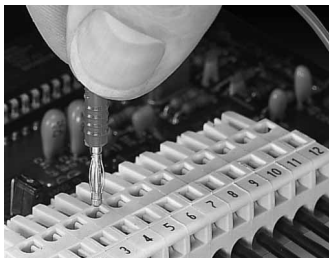
Prüfen mit Prüfstecker Ø 2 - 2,3 mm
