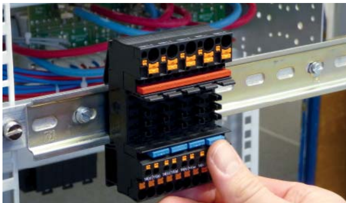
2 Steckbrücken für die Sammelsignalisierung einschieben (hier: Reihenschaltung der Signalkontakte).
