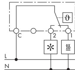
\* Das Kontaktöffnen und Kontaktschliessen bezieht sich auf den Temperaturanstieg. Der Öffner für die Heizung öffnet und der Schliesser für den Lüfter schliesst, wenn der vorgegebene Wert überschritten wird.
