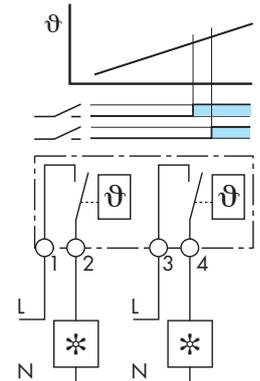
\* Das Kontaktöffnen und Kontaktschließen bezieht sich auf den Temperaturanstieg. Der Öffner für die Heizung öffnet und der Schliesser für den Lüfter schliesst, wenn der vorgegebene Wert überschritten wird.
