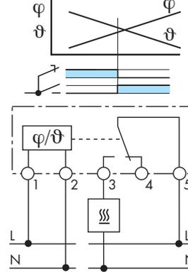
\*Der Schliesser schliesst, wenn die Feuchtigkeit den eingestellten Wert überschreitet und/oder beim 1T.91.8.230.4050 die eingestellte Temperatur unterschritten wird
