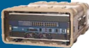
2100, el TCP ofrece una flexibilidad máxima de comunicaciones. El TCP integra elementos de múltiples comunicaciones y los dispositivos de encriptación en una maleta de transporte robusta para aplicaciones de despliegue rápido. Con su sistema de cableado modular, la reconfiguración para las exigencias de nuevas misiones es simple.
