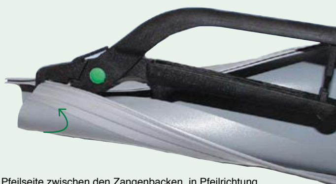
5. Pfeilseite zwischen den Zangenbacken, in Pfeilrichtung (s. auch Z-Zange), in das U-Profil einführen. Feed the arrow-profile between the plier's jaws (observe also the Z-plier) into the U-profile.
