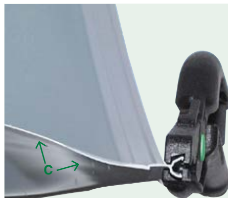
4. Z-Zange locker halten und ca. 20 mm über U-Profil führen. Hold the Z-plier loosely and begin 20 mm from head of U-profile.
