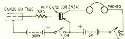
Fig. 4—Grounded-emitter amplifier.
