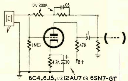
Fig. 2—A Titone feedback circuit.
