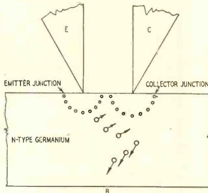
Fig. 2—The point-contact p-n-p type.
