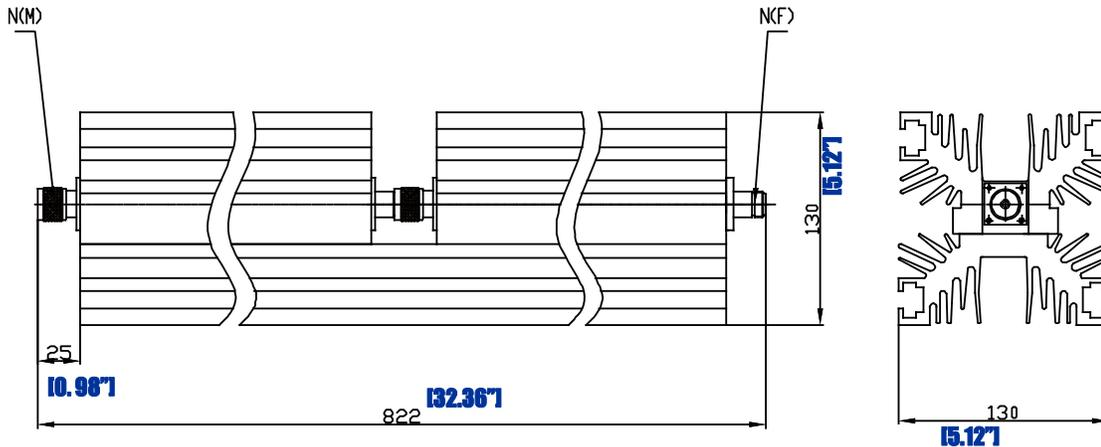
**1K WATTS ULTRA HIGH POWER DC-6GHz ATTENUATOR**
