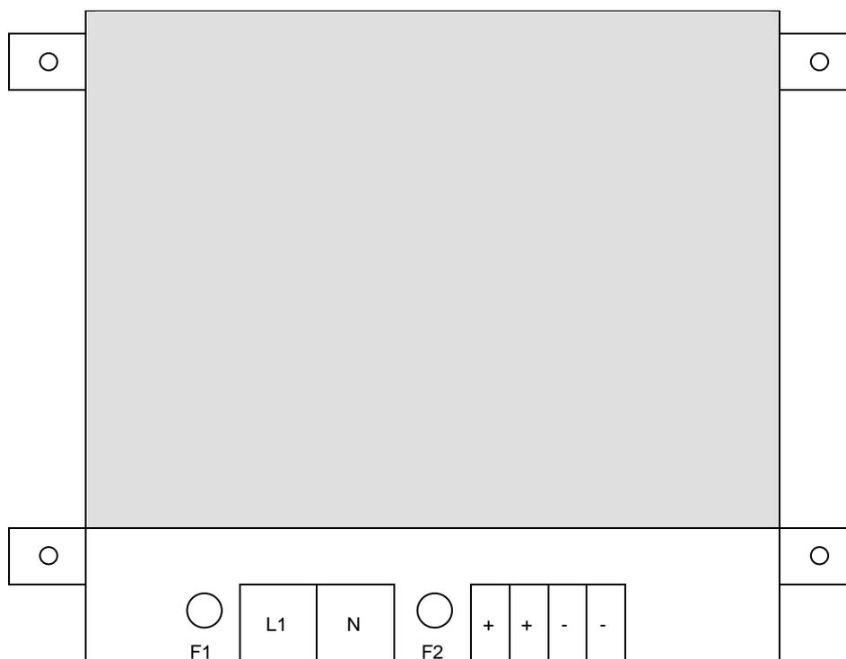
F1 für primärseitige Absicherung, F2 für sekundärseitige Absicherung
