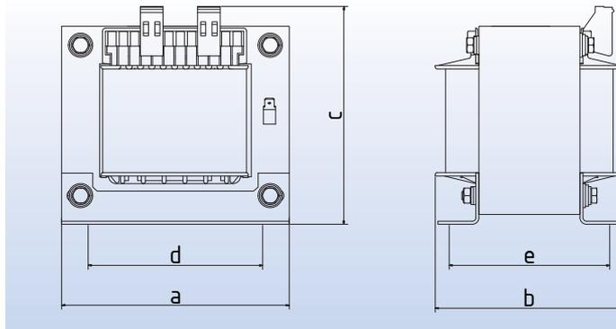
**Einphasen-Netztransformatoren nach VDE 0570 Teil 2-1, EN 61558-2-1**
