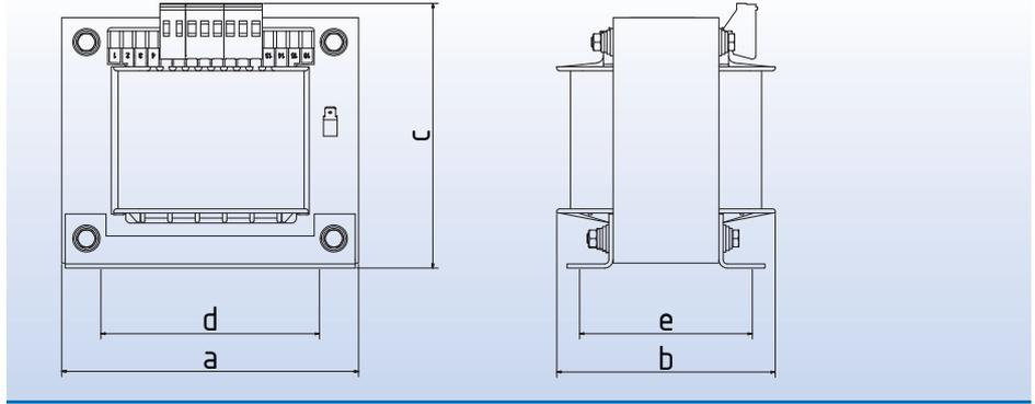
**Einphasen-Spartransformatoren nach VDE 0570 Teil 2-13, EN 61558-2-13**
