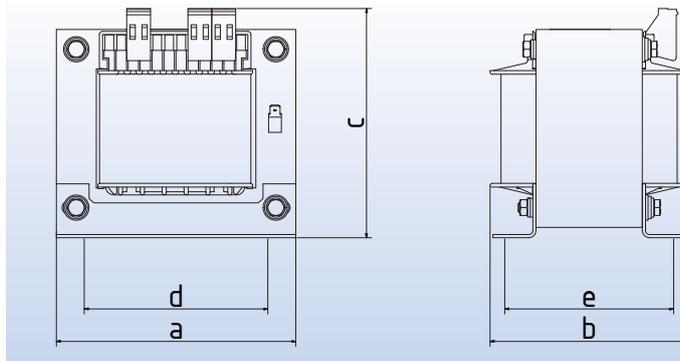
**Einphasen-Steuertransformatoren nach VDE 0570 Teil 2-2, EN 61558-2-2**
