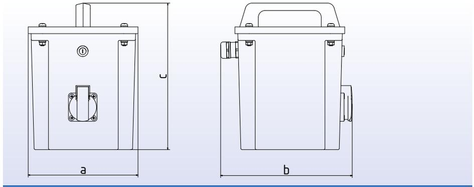
**Einphasen-Trenntransformatoren nach VDE 0570 Teil 2-4, EN 61558-2-4**
