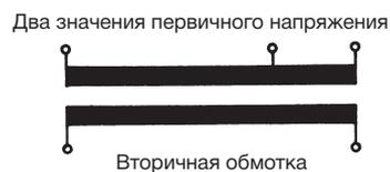
Требования по запасу диапазона по обмотке также не возникает, если второе напряжение первичной обмотки равно половине напряжения первичной обмотки (например, 115 В – 230 В).
