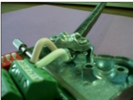
**7.** Serrer les embouts dans le bornier. Environ 0.3 à 0.4 Nm. Vérifier le sens de montage & l'assise de la bride puis serrer les 2 vis auto-taraudeuses.
