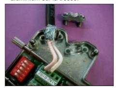
**6.** Vérifier le sens de sortie capot (gauche ou droite) puis casser l'opercule concerné à l'aide d'une pince. Mettre en position l'ensemble dans le serre câble.
