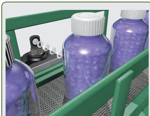
Conteggio pezzi: un sensore 873M conta le bottiglie che, essendo colorate, trasparenti e lucide, potrebbero essere difficili da rilevare con sensori fotoelettrici.
