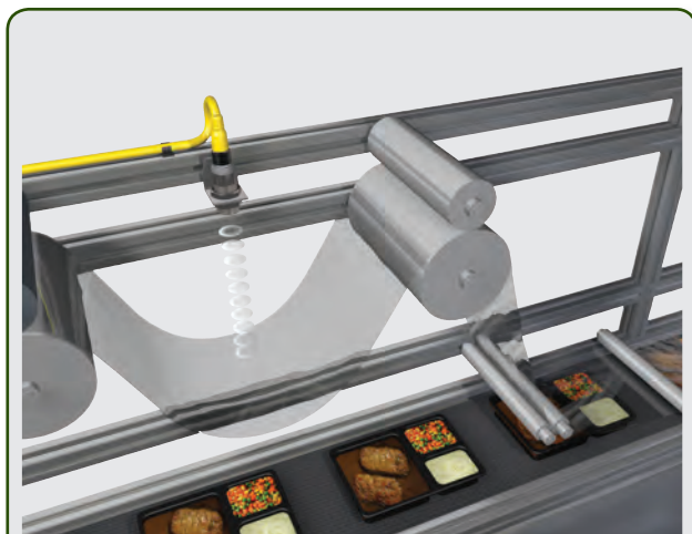
Rilevamento della posizione della pellicola: un sensore 873M ad ultrasuoni controlla l'avanzamento continuo di una pellicola trasparente monitorando la tensione.
