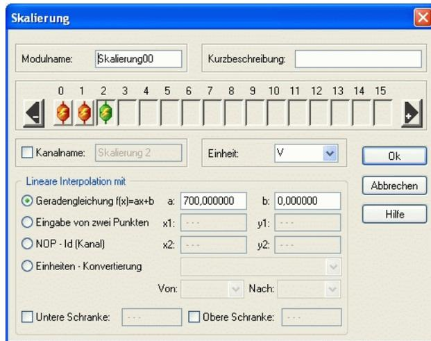
**Abbildung 3-6.** Lineare Skalierung der drei Eingangskanäle
