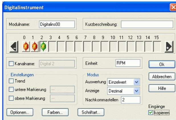
Abbildung 3-8. Einstellungen des Digitalinstruments
