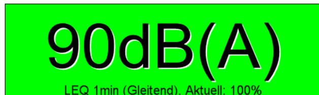
Zum Beginn der Messung stehen noch keine Daten für eine gesamte Intervalldauer zur Verfügung. In diesem Fall wird der prozentuale Anteil der bereits verstrichenen Zeit am Messintervall unter dem LEQ Wert angezeigt. Ist die volle Intervalldauer erreicht, so bleibt diese Anzeige auf 100%.
