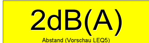
Er zeigt den am Ende des aktuellen Messintervalls zu erwartenden Unterschied zwischen dem Grenzwert und dem Messwert an, der sich ergeben würde, wenn die Lautstärke für den Rest des Intervalls der Lautstärke im verstrichenen Intervall des Kurzzeit LEQs entsprechen würde.
