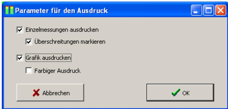
Ist die Option **Überschreitungen markieren** aktiviert, so werden die Werte, bei denen die Grenzwerte überschritten sind mit einem Rahmen versehen, so dass sie leichter zu erkennen sind.
