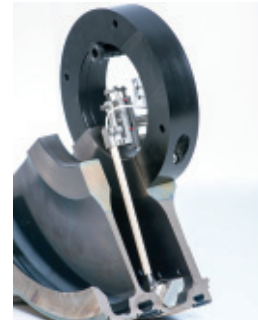
Manipulator tauglicher Sensor, angepasst zur Prüfung in komplexer Geometrie
