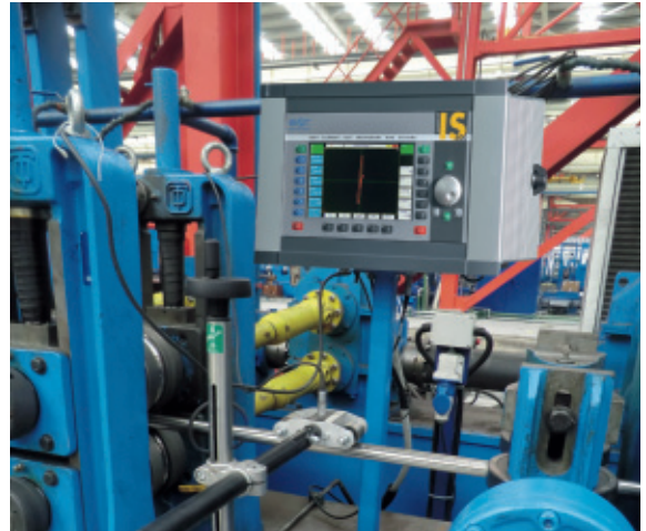
Prüfung der Schweißnaht
