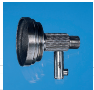
Risserkennung im Zahngrund, berührungslos
