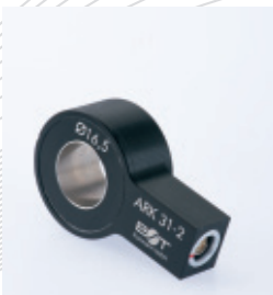
ARK 31-2, Standardsensor zur Rissprüfung an mehrlagigen Aluminiumstrukturen
