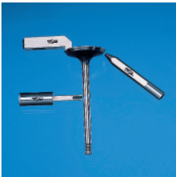
Poren, Risse und Schweißfehler an Mehrstoff-Ventilen
