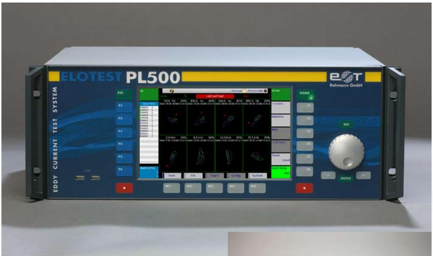
**Die Mehrfrequenz-Sortierprüfung mit dem PL500Q hat sich im praktischen Einsatz bewährt. Sie kombiniert die einfache Bedienung über einen automatischen Lernprozess mit der Sicherheit, nichts zu übersehen. Mit bis zu acht Prüffrequenzen wird ein „Fingerabdruck“ der erlernten Gutteile erstellt. Alle weiteren Teile werden hiermit verglichen. Abweichungen im Material, der Wärmebehandlung oder anderer elektromagnetisch erfassbarer Werkstück-eigenschaften werden so sicher gefunden.**
