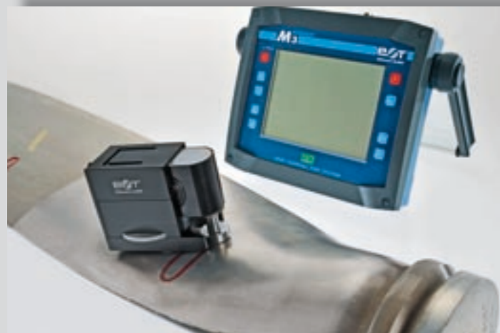
Dynamische Oberflächenrissprüfung am Rotorblatt
