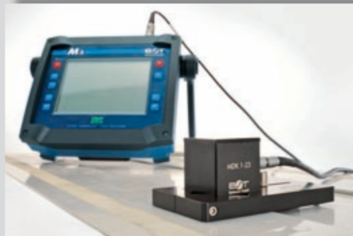
Prüfung auf verdeckte Risse in Aluminium-Nietstrukturen
