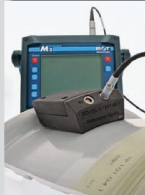
Manuelle Oberflächenrissprüfung mit angepasstem Kontursensor
