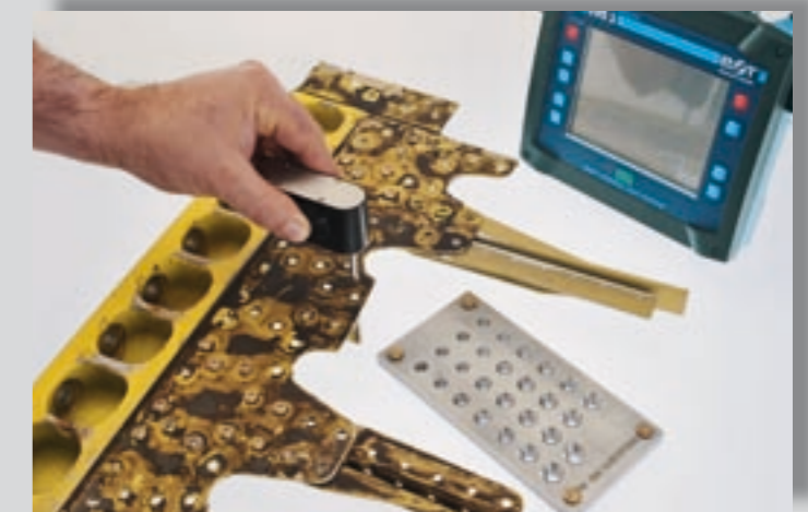
Bohrungsprüfung mit Minirotor an Aluminiumstrukturen
