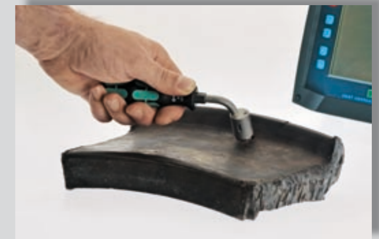
Prüfset für raue Umgebungsbedingungen mit Riss-Indikation direkt am Sensor über LED
