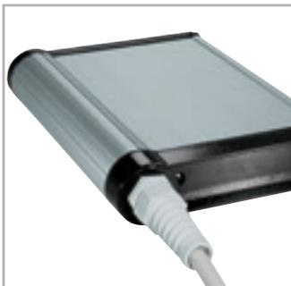
Adapter mit Kabelverschraubung.
