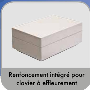
**Coffret :** Alliage en fonte d'aluminium EN AN-44300 DIN EN 1706(GD AL SI 12 / DIN 1725). Inclinaison de démoulage de 1°, les cotes intérieures diminuent de 1° sur tous les côtés jusqu'au fond du coffret.
