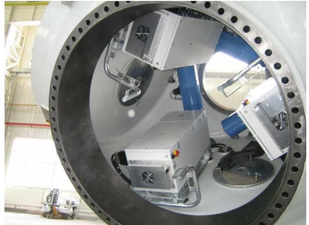
Drei Pitchsteuerungen von HARTING in einer W2E Windradnabe
