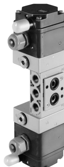
5/2-weg magneetventiel, tweezijdig aangestuurd, met 2 borgstanden, K_{vs} -waarde 1,4, aansluiting G 1/4 /NAMUR
