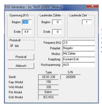
Im "NUR LESEN" -Modus registriert die Software alle am ESD-Generator vorgenommenen Bedienungen. Diese Funktion ermöglicht eine Mitschrift der manuellen Testabläufe, die während des ESD Tests durchgeführt werden.
