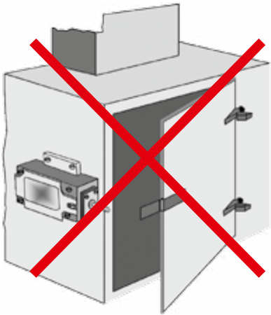
Abb. 33 Unzulässige Anbringung eines Positionsschalters Bauart 1
