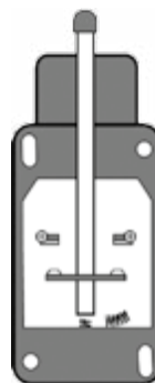
Abb. 10 Positionsschalter, Prinzip der Zwangsöffnung
