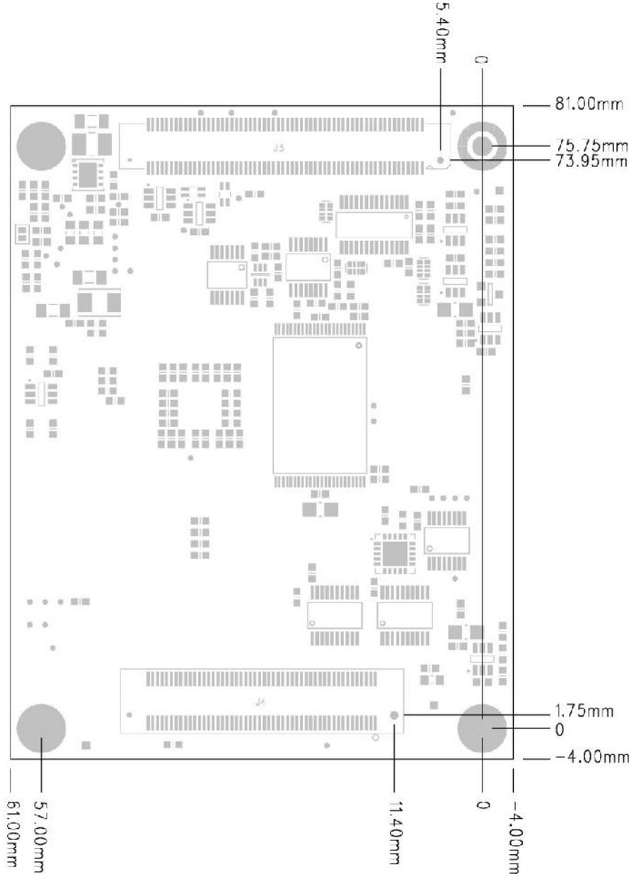
**FIGURE B4 - BOTTOM SIDE CONNECTOR POSITIONS**
