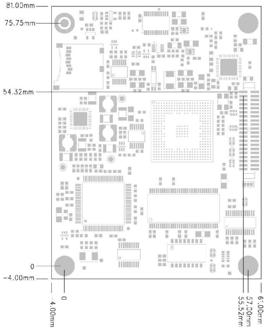
**FIGURE B3 - TOP SIDE CONNECTOR POSITIONS**
