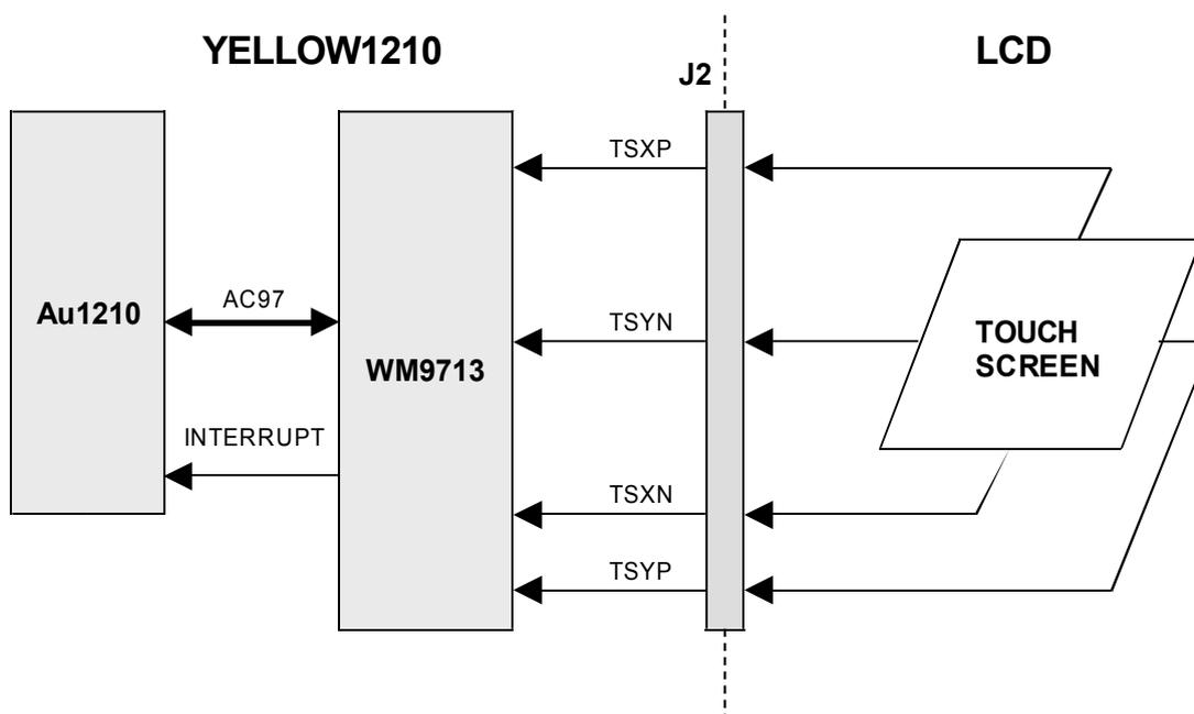
**FIGURE 3 - YELLOW1210 TOUCH-SCREEN BLOCK DIAGRAM**
