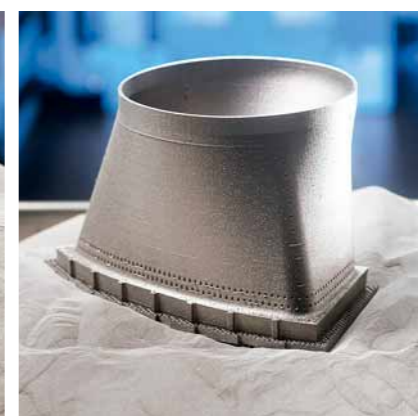
Schicht für Schicht: Funkenschlagend schmilzt der Laser das neue Bauteil aus dem Metallpulver. Gesteuert wird er von einem Computerprogramm.
