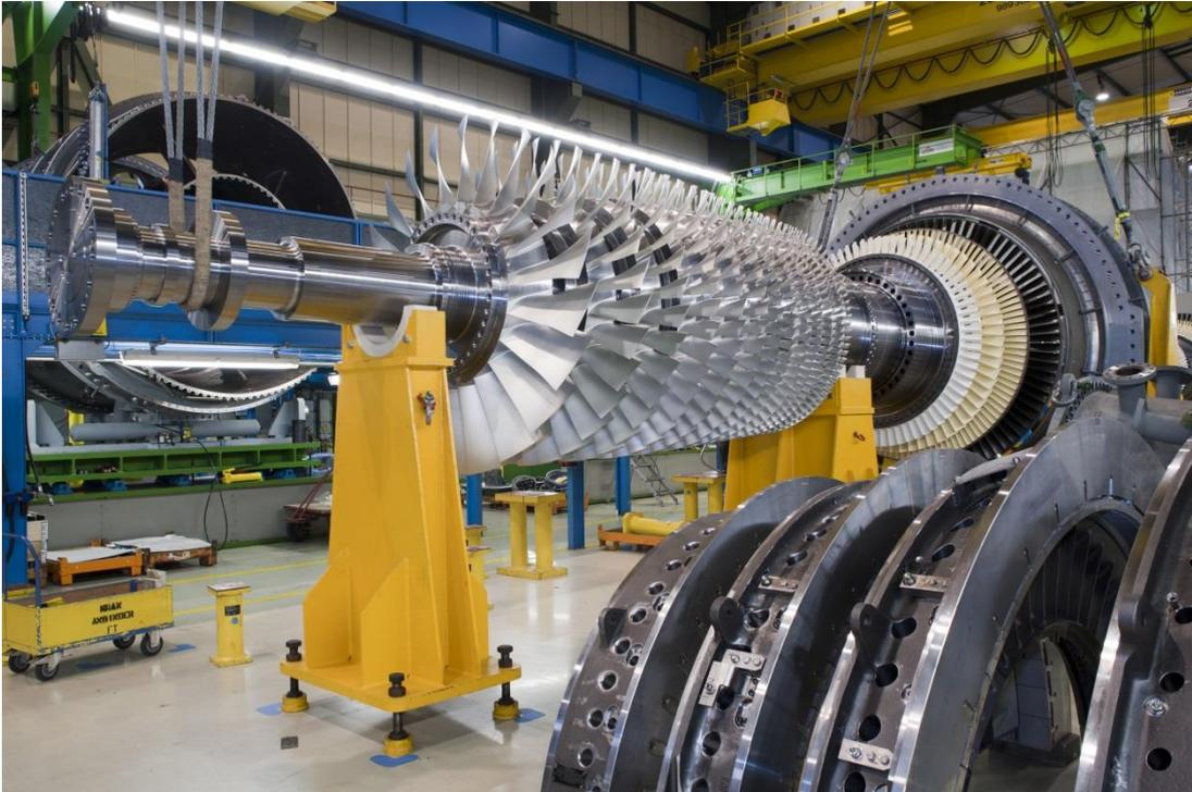
Siemens produziert fünf Gasturbinen des Typs SGT6-5000F im Siemens Dammam Energy Hub in Saudi Arabien.
