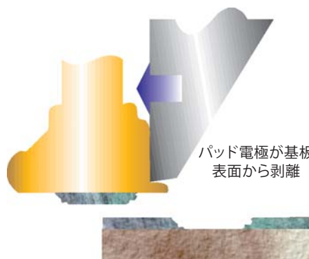
破断モード 5 - パッド剥がれ
