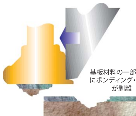
破断モード 6 - クレータリング
