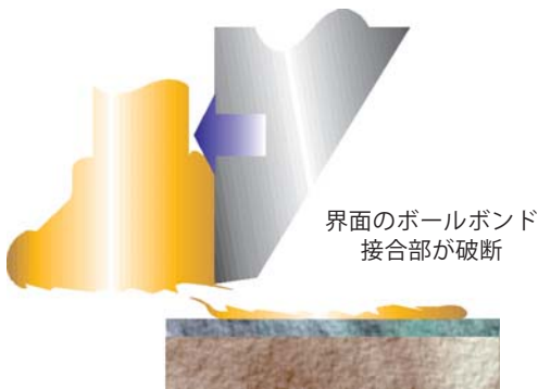
破断モード 3 - ボンド破断 (金属間化合物の破断)
