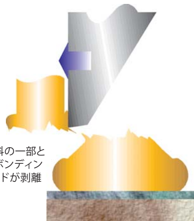
破断モード 7 - ワイヤ破断 (設定ミス)
