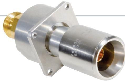
Die Antwort auf diese Anforderung ist der vollkommen neu entwickelte SPINNER EasyDock. Der SPINNER EasyDock ist ein federnd gelagerter Messadapter, welcher auch dann sicher und zuverlässig Kontakt herstellt, wenn Prüfling und Adapter nicht zu 100 Prozent auf der gleichen Achse liegen. Gleichzeitig bleibt die hohe Messgenauigkeit von der mechanischen Toleranz vollkommen unbeeinflusst.
