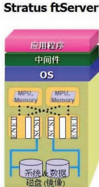
图2、容错系统可靠性全部基于硬件
