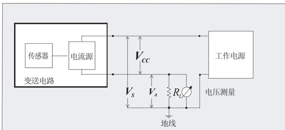
图 3：二线制的应用电路
