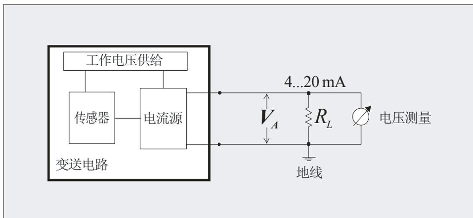
图 2：完整的电流信号变送电路
