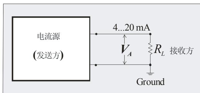
图 1: 4-20mA 电流信号传输原理图
