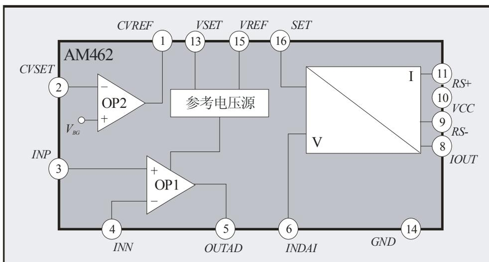
图 4: 电压电流转换变送集成电路 AM462
