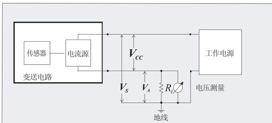
图 3: 二线制的应用电路
