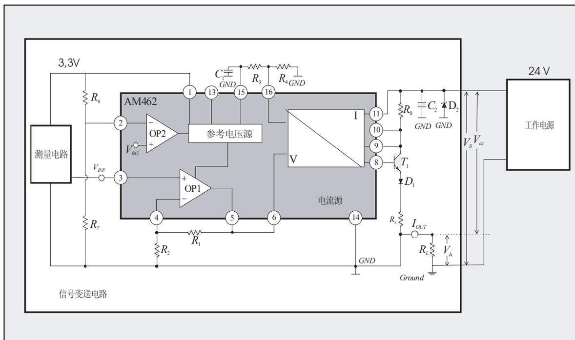
图 6: AM462 与测量电路 (AM462 提供 3.3V 工作电压)
