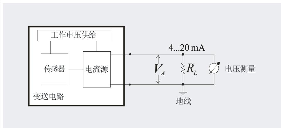
图 2: 完整的电流信号变送电路
