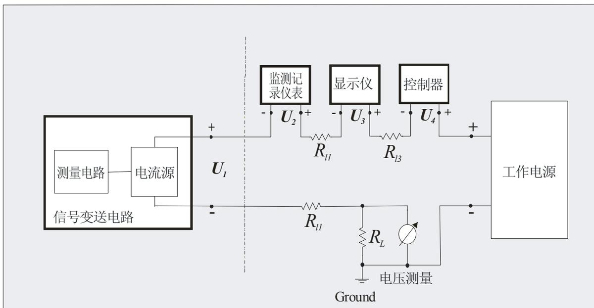
图 7：控制系统的电流变送技术应用
