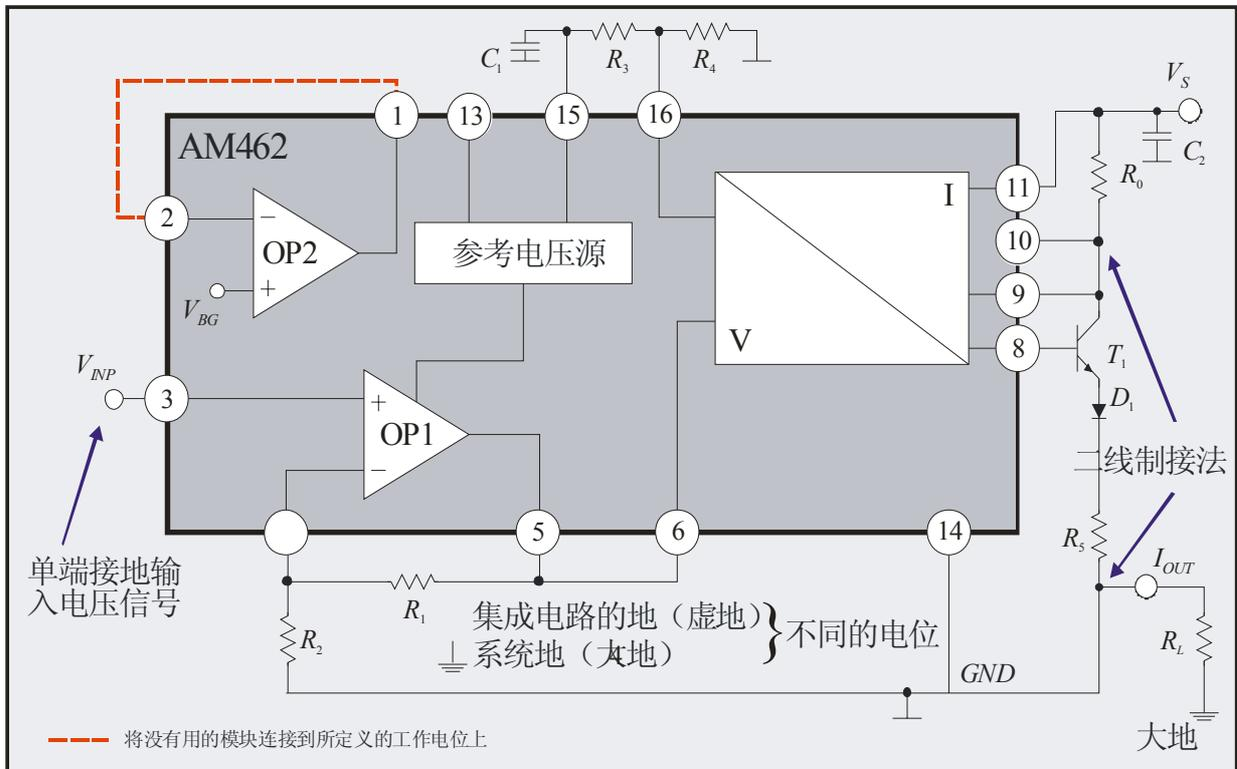
图 5: AM462 的二线制 4-20mA 的应用电路图
