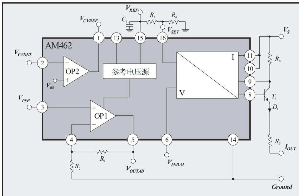
图 7: AM462 的 3-线制 4-20mA 电流变送输出电路
