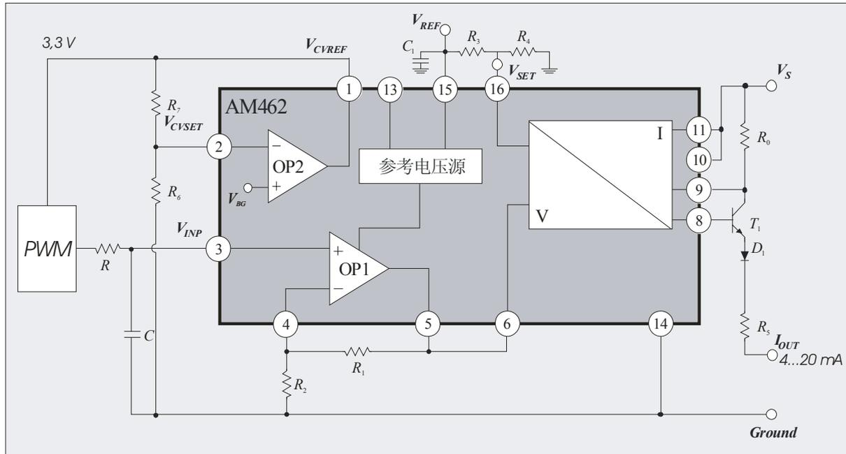
图 8：通过 AM462 将 PWM 信号变送为 3-线制的 4-20mA 电流输出信号
