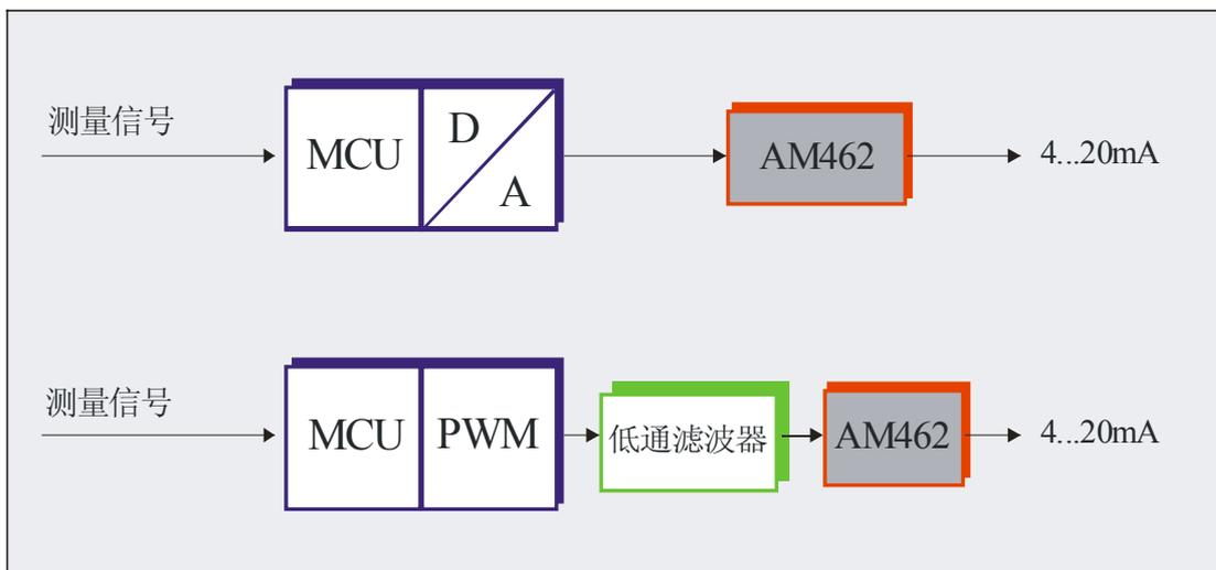
图 2：应用 AM462 将测量信号转换成 4-20mA 电流输出的多种可能性
