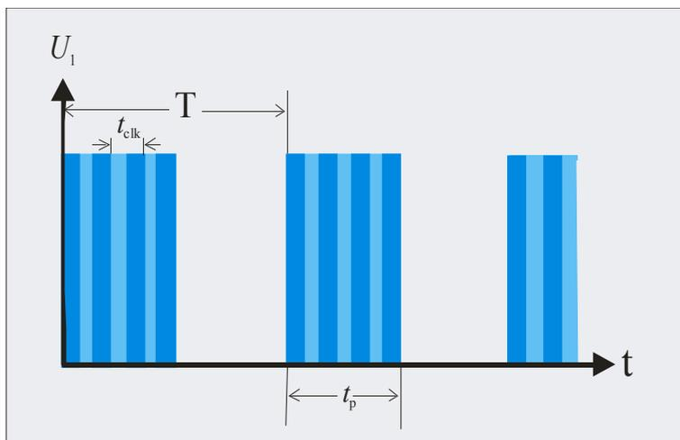
图 3：PWM 脉冲宽度  $t_p$  定义示意图
