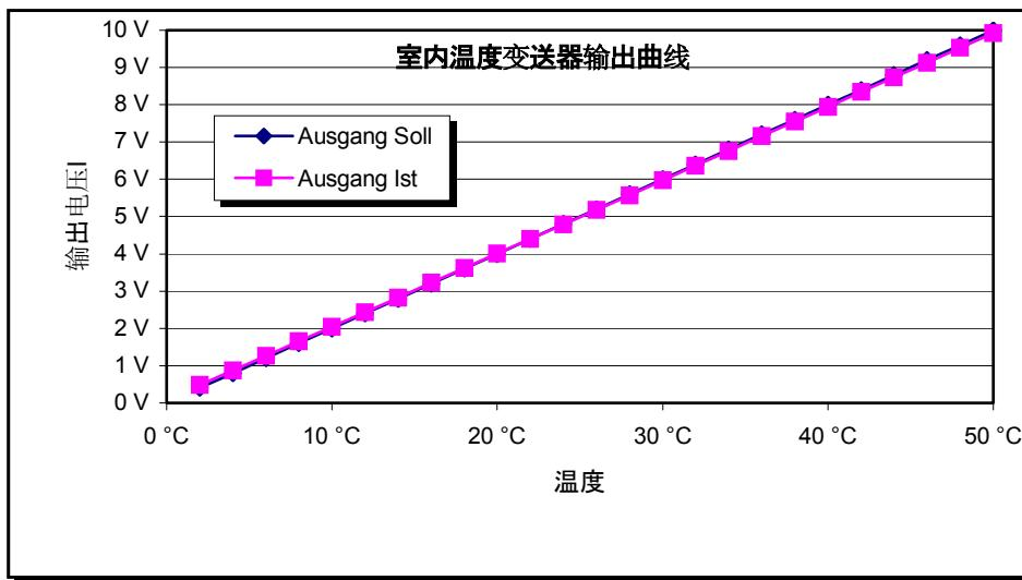
图 4：室内温度变送器的输出曲线
