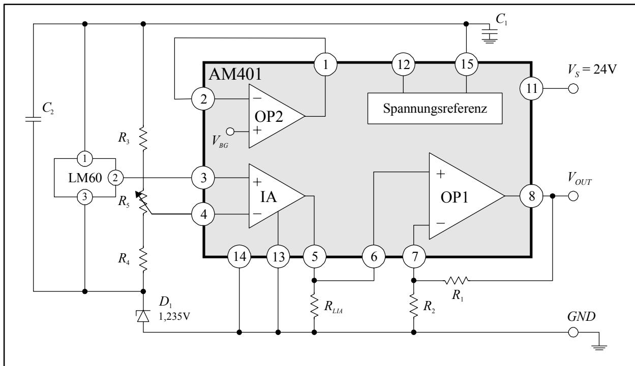
图 2: 室内温度变送器电路图
