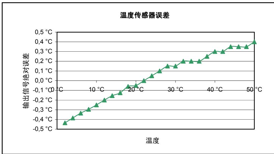
图 5: 室内温度变送器的绝对误差
