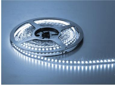
Flexibler LED-Streifen 19,2 W/m, 240 LEDs/m in Doppelreihe, 15 mm breit, 5 m lang (auf Rolle abgepackt), dimmbar, alle 5 cm trennbar, selbstklebend
