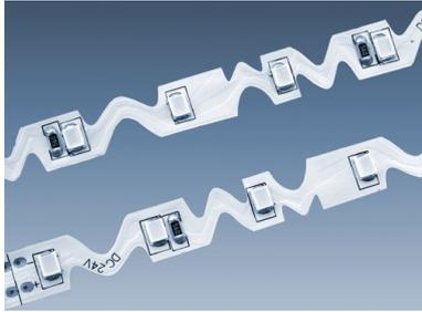
Hochflexibler, biege- und knickbarer LED-Streifen (LED-Zickzack-Streifen), aufgrund S-förmigen Trägerstreifens in nahezu beliebiger Form installierbar. 12 W/m, 60 LEDs/m, 8 mm breit, 5 m lang (auf Rolle abgepackt), dimmbar, alle 10 cm trennbar, selbstklebend
